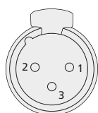
SALIDA DMX Conectores XLR (vista trasera)
