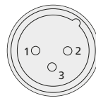
DMX-EINGANG XLR-Montagestecker (Rückansicht)
